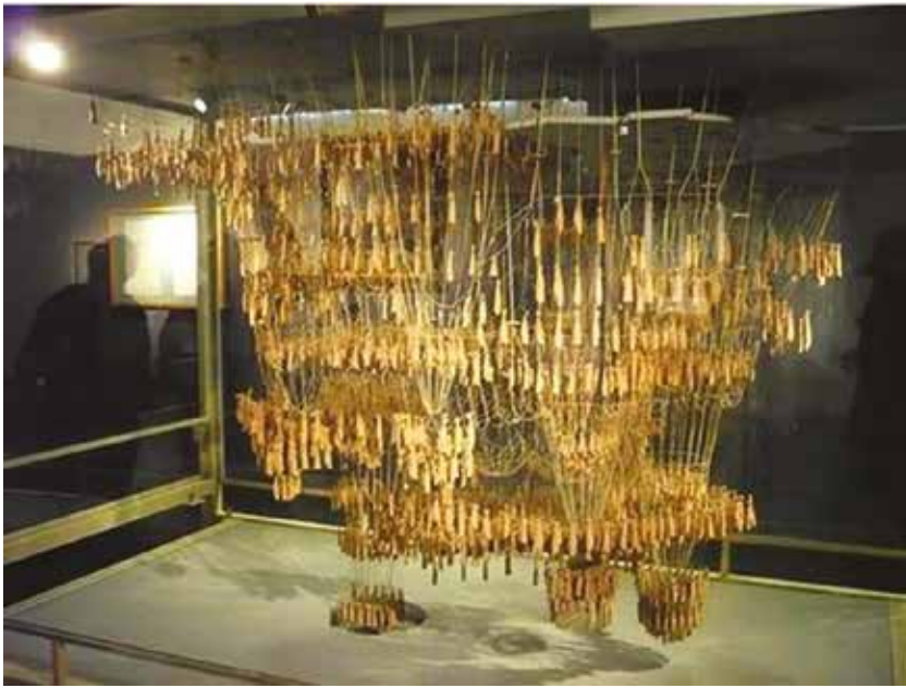
Fig. 10 | Modelli in scala di archi catenari
