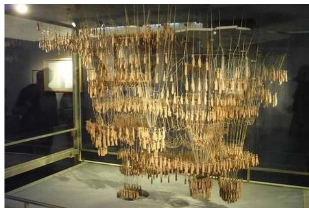
20. Modello in scala di archi catenari
